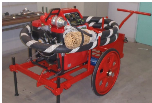
可搬式消防ポンプ
