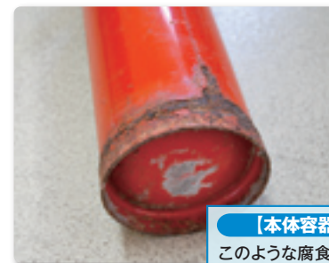
溶接部とその周辺の腐食
