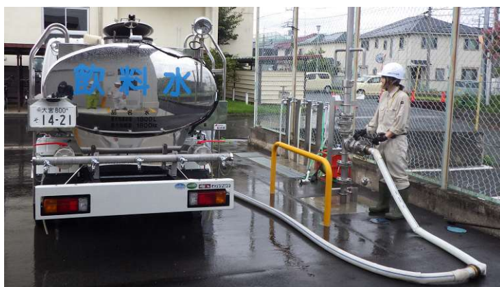
5.給水車への注水
